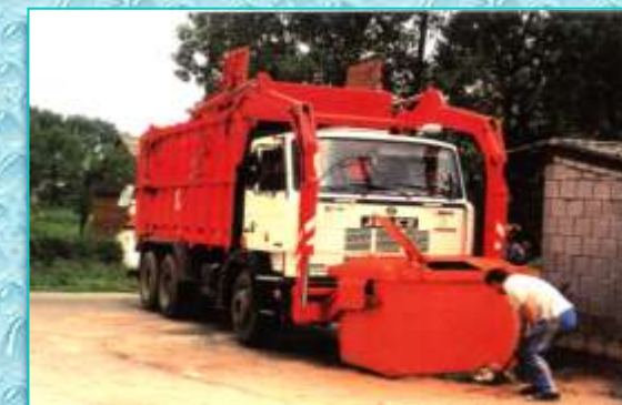
Samochód typ SM-11 z przednim załadunkiem odpadów z pojemników 2,2 m 3
