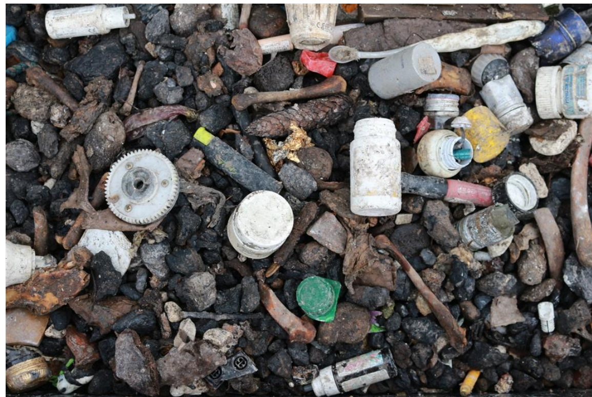
frakcja lekka po procesie separacji wodnej
