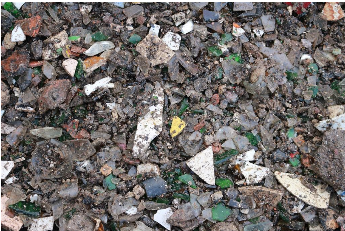
frakcja ciężka po procesie separacji wodnej
