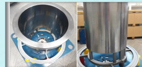
Dyfuzor po oczyszczeniu i nałożeniu warstw
