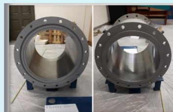
Płaszcz krystalizatora po oczyszczeniu i nałożeniu warstw
